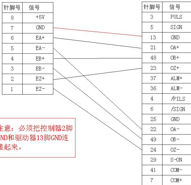
松下A5伺服驱动器和ECI1800控制卡辅助编码器接线参考图
