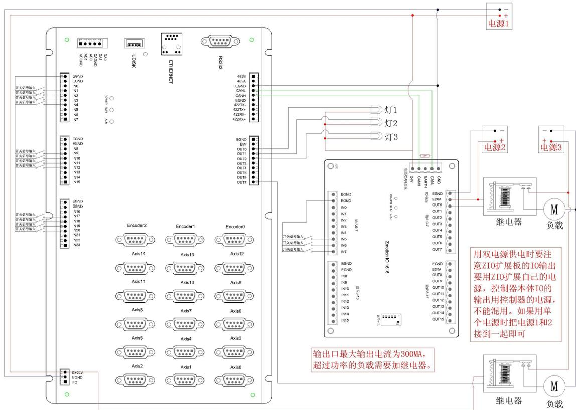
用双电源供电时要注意ZIO扩展板的IO输出要用ZIO扩展自己的电源，控制器本体IO的输出用控制器的电源，不能混用。如果用单个电源时把电源1和2接到一起即可
