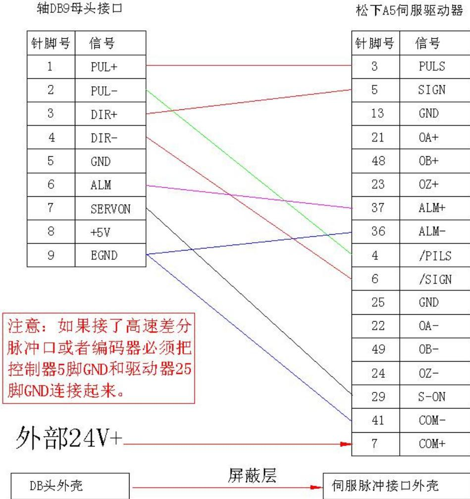
松下A5伺服驱动器低速差分脉冲口连接ZMC316控制器接线参考
