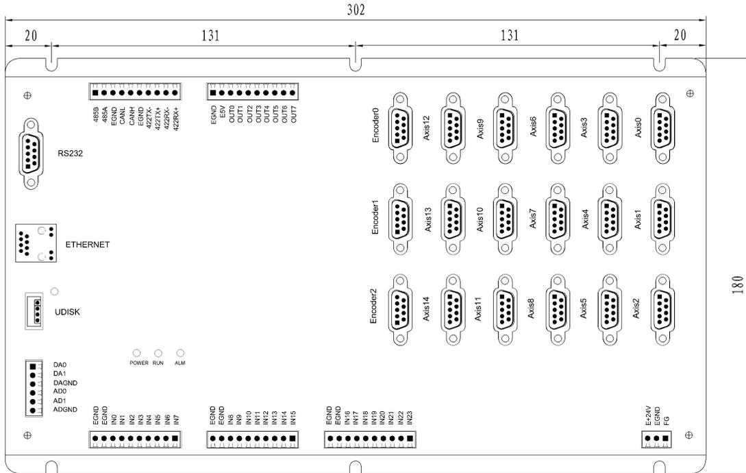
单位: mm      安装孔直径 4.5mm
