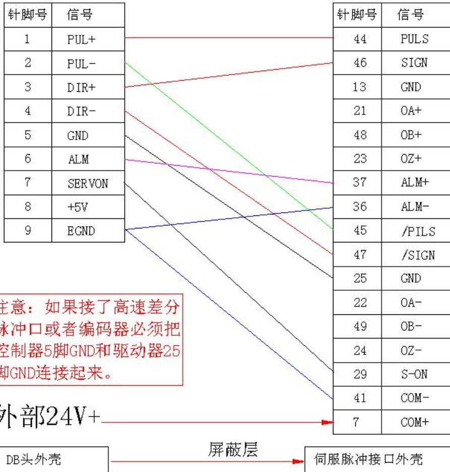
松下A5伺服驱动器高速差分脉冲口和ZMC316控制器连接参考图
