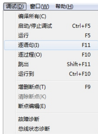
▲ 程序诊断 | 可设置断点，逐语句、逐过程调试程序
